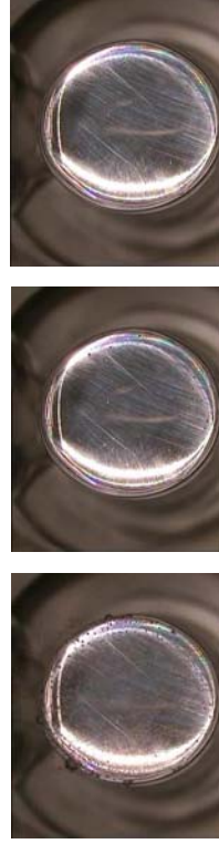
FIG. 4_15. Corrosión Electroquímica Electrochemical corrosion
